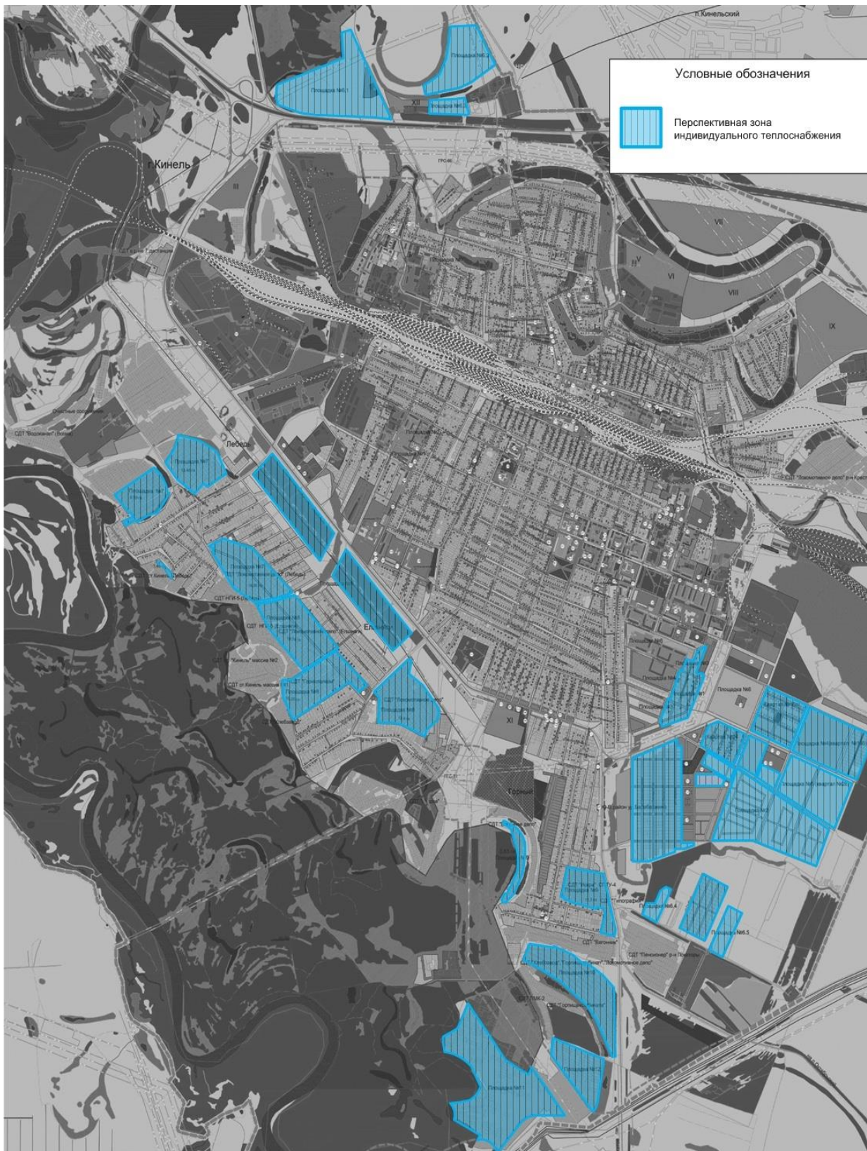
Рисунок 2.3.4 – Перспективные зоны действия индивидуальных источников тепловой энергии г. Кинель при 3 варианте развития
