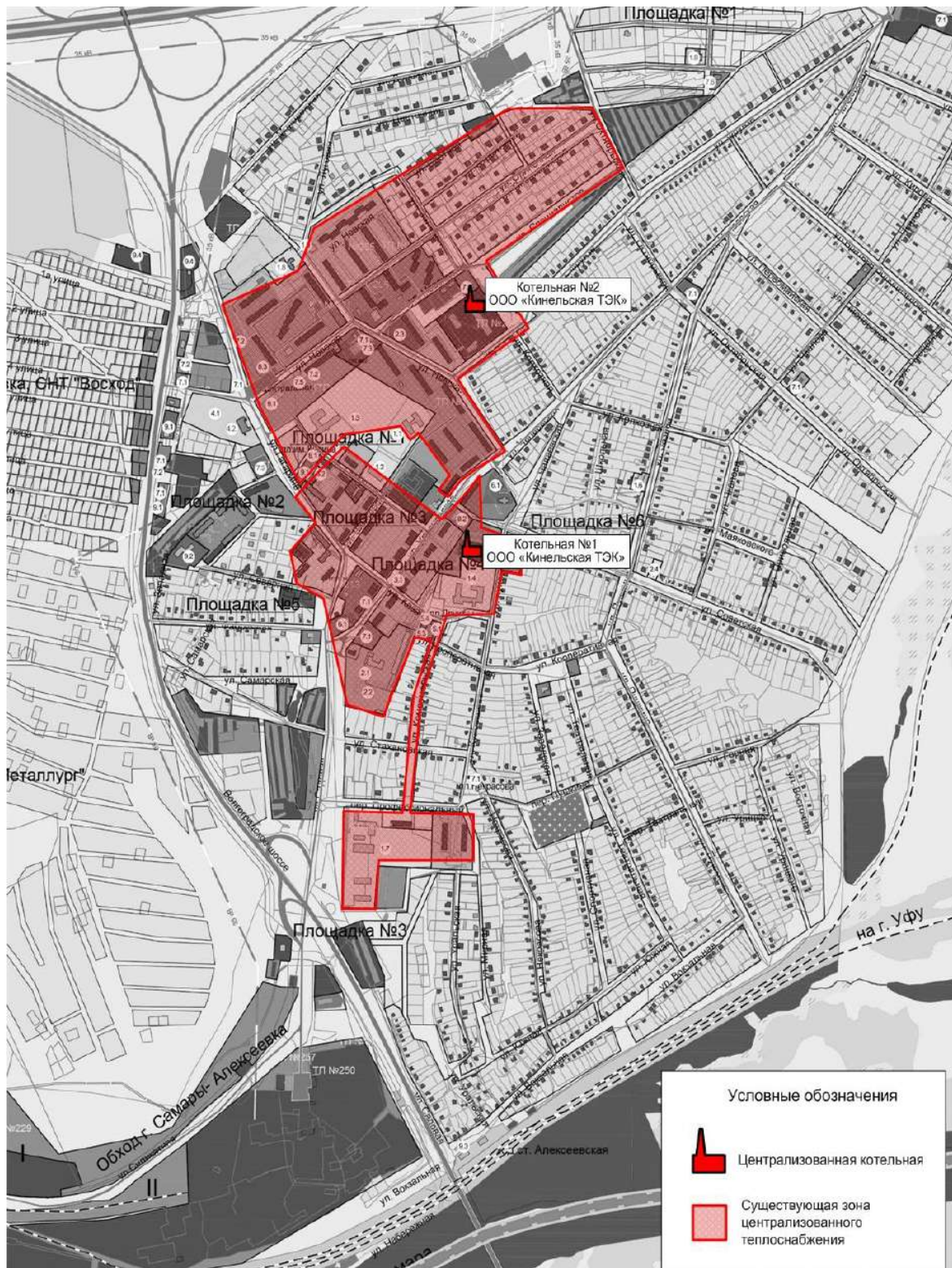
Рисунок 1.1.1.2 – Зона действия централизованных систем теплоснабжения п.г.т. Алексеевка
